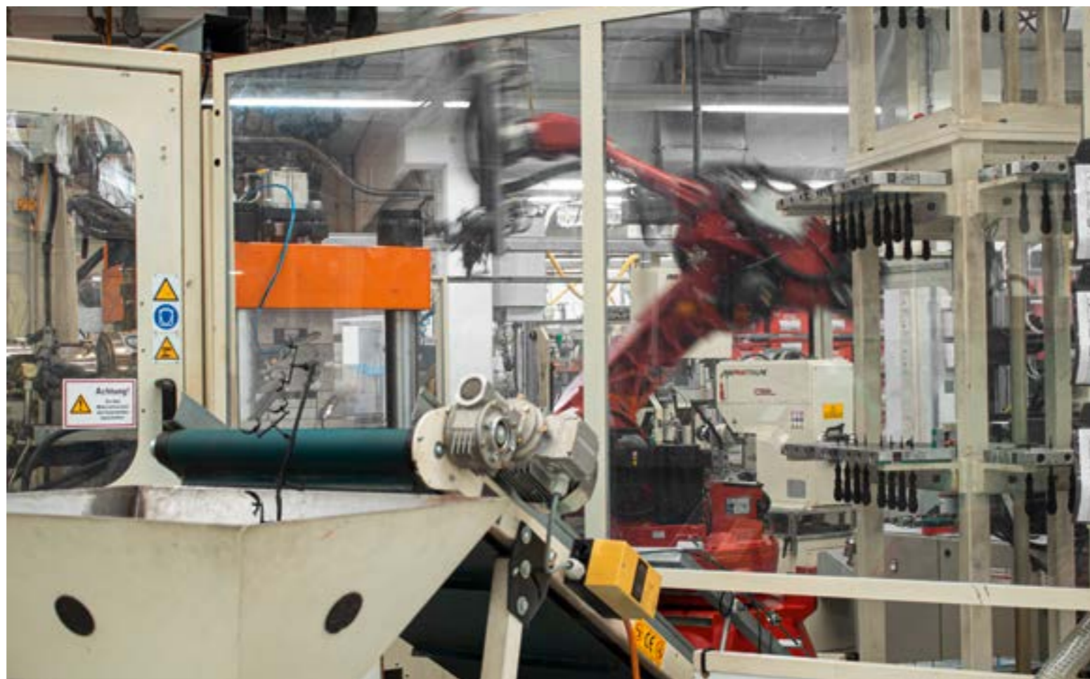
Erste Schritte des Regranulierungs-Prozesses: Zuführen der Anguss-Abfälle in die dafür vorgesehene Mühle.
